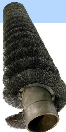
Вал щеточный спиральный изготавливается из полосовой щетки, которая в процессе производства завивается в спираль и устанавливается на вал. Материал ворса (стальной, латунированной, нержавеющей стали, латунный, полимер-абразивный).
