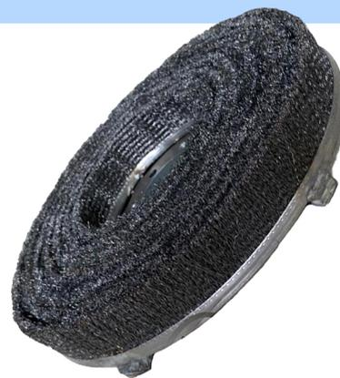
Щетка проволочная дисковая Dвн100 мм\_n1150 об/мин\_Dн380 мм для удаления окалины с поверхности катанки. Тип: торцевая металлическая, наружный диаметр 380 мм, внутренний диаметр 100 мм, материал: проволока стальная, диаметр 0,3 мм. Характеристики: щетка предназначена для тонкой очистки катанки от остатков окалины после ее обработки в окалиноломателе волочильного стана MEKOSAN.
