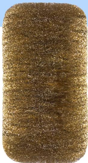
Брашировальный вал с ворсом из гофрированной латунированной стальной проволоки диаметром 0,25 - 0,30 мм применяется на барабанных шлифованных станках. Предназначен для средней агрессивности браширования (брашировка, текстурирование) плоских изделий из разных пород древесины.
